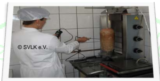
Kerntemperaturmessung eines Dönerspießes
